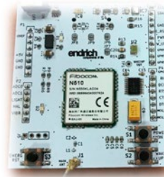
5. ábra. Második lépés – Endrich IoT szenzor és kommunikációs pajzs
