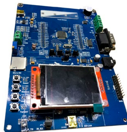
2. ábra. GD32150R-EVAL kiértékelő panel a GD32® Cortex®-M3 GD32150R8T6 mikrokontrollerhez
