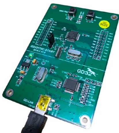
4. ábra. Kezdőkészlet a GD32F103C8T6 GigaDevice GD32™ ARM® Cortex®-M3 mikrokontrollerhez
