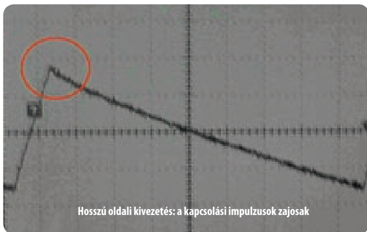
Rövid- és hosszúoldali kivezetésű áramérzékelők összehasonlítása DC/DC konverterben való használatkor, a kapcsolási zajok szempontjából
