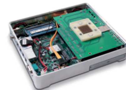
Docking station PC: A felső részen a 100 pólusú dokkoló csatlakozó, belül az alaplap elrendezése látható
